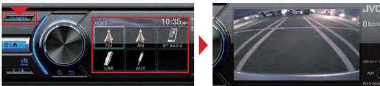
Über den rückseitigen Cinch-Eingang können Sie eine beliebige Rückfahrkamera anschließen.
